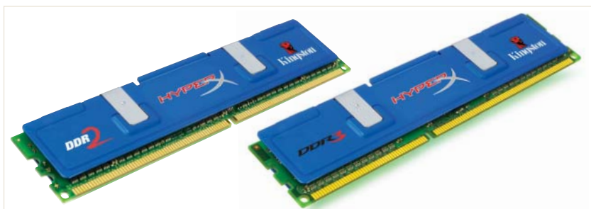
PAMĚŤOVÉ MODULY: DDR3 se liší od stávajících DDR2 i podobou, mají jinde umístěný zářez, takže je nelze zaměnit. DDR2 vlevo, DDR3 vpravo.
