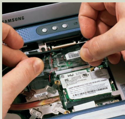
Jednoduše a bezpečně: Anténu WLAN karty je třeba přichytit lepicí páskou.
