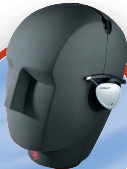
Pan Neumann: Pro testování sluchátek používá Chip umělou hlavu K 100 (cca 18 000 Kč) firmy Neumann.
