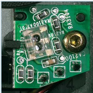
Čidlo: Snímá polohu média. Bez něj by LS nefungoval.
