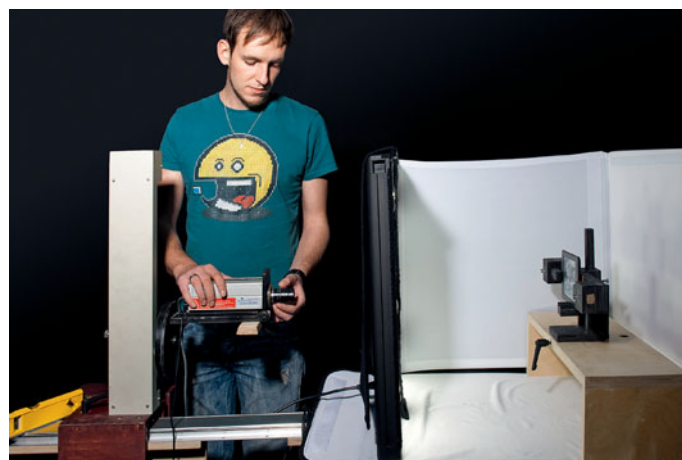
Speciální kamera zaznamenává, zda je displej osvětlen rovnoměrně. Při měření používá 1 300 000 kontrolních bodů.
