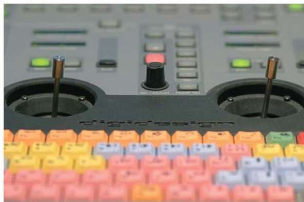
Joystick, kterým se ovládá prostorové rozložení zvuku v kinosále
