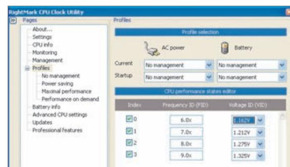
**Snižte napátí:** Pomocí programu RMClock nastavíte procesor tak, že spotřebuje méně energie. V běžném provozu to nebude vadit.
