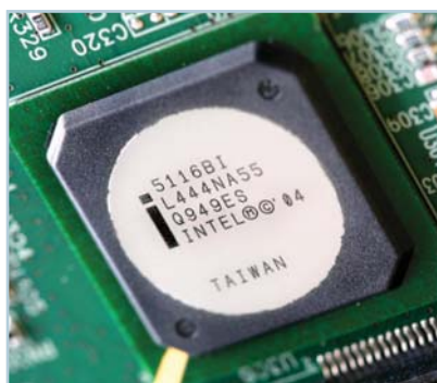
Chip Intel PRO/Wireless 5116 použitý v jednotkách BreezeMAX CPE PRO.
