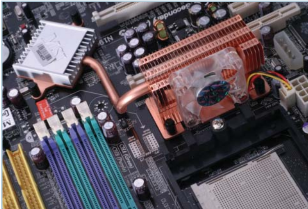
Základní deska MSI je vybavena aktivním chlazením čipové sady.
