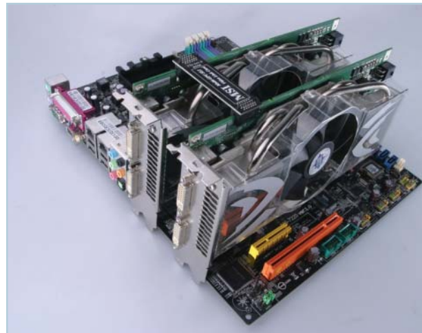
Dvě grafické karty na základní desce zaberou většinu místa i s některými volnými sloty.
