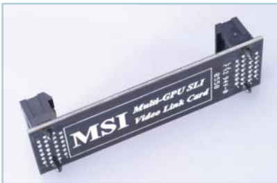
Můstek pro spojení dvou SLI grafických karet.
