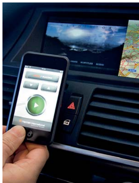
Elegantní dálkové ovládání: Rádio s procesorem Atom lze ovládat i ze zadní sedačky - pohodlně pomocí iPodu touch.
