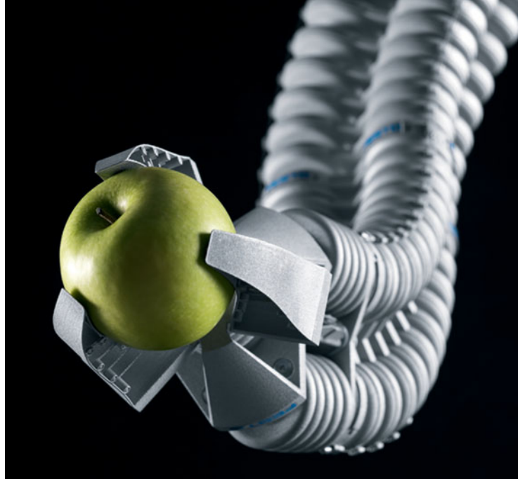
Manipulační chapadlo Bionic Handling Assistant se pohybuje pomocí proudu stlačeného vzduchu a funguje podobně jako sloní chobot. Předměty umí uchopit jemně, ale pevně.
