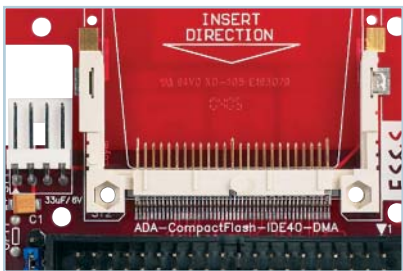
Paměťová karta jako pevný disk: S adaptérem od firmy ES&S uděláte z paměťové karty CompactFlash pevný disk.
