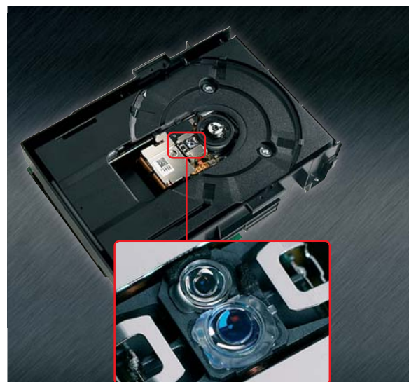
DVOJITÁ ČOČKA Pro Blu-ray (nahore) a CD/DVD (dole) jsou ve vypalovačkách „pick-upy“ s dvěma čočkami.
