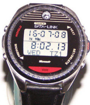
Hodinky Timex Datalink z roku 1994 fungovaly jako adresář a kalendář a s počítačem komunikovaly bezdrátově pomocí optického senzoru a blikajících pruhů na monitoru.
