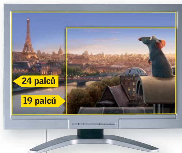
VÍCE PROSTORU: 24palcové monitory přináší na displeji s 2,3 megapixelu výrazně více obrazových informací než 19palcová „téeftěčka“ s 1,3 megapixelu.
