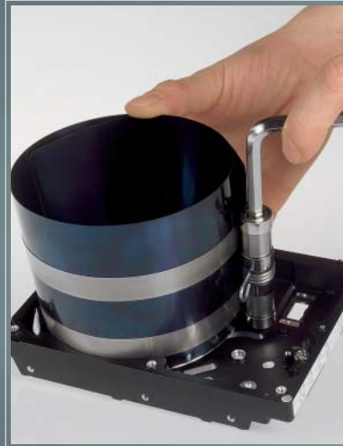
7 VÝMĚNA MAGNETICKÝCH PLOTN: Upínací pás pístitních kroužků (autoopravárenský přípravek) zajistí, aby se nezměnila vzájemná poloha ploten.
