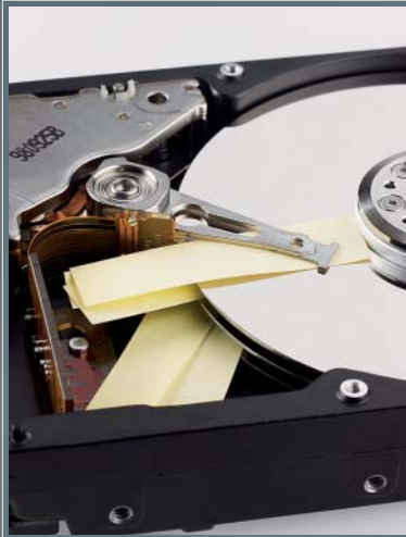
6 NÁHRADA ZÁZNAMOVÝCH HLAVIČEK: Při výměně hlav zabrání papírové proužky jejich dotyku s magnetickými plotnami.
