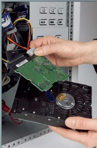
5 VÝMĚNA DESKY: Kritickou startovací rutinu lze obejít výměnou řídicí desky za provozu.
