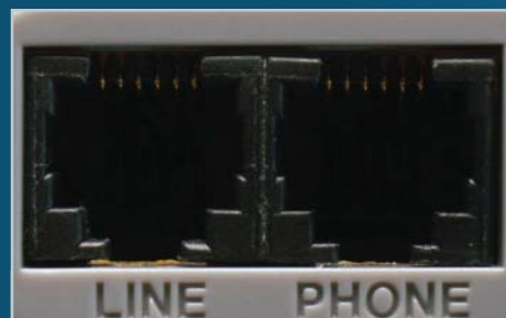
FXS A FXO: Vlevo připojte kabel od operátora, vpravo telefon.
