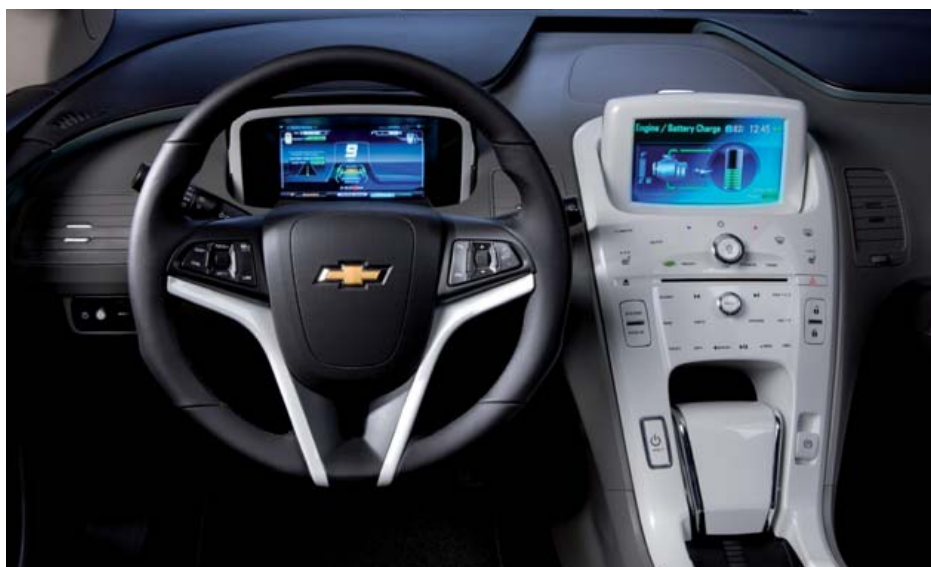
Chevrolet Volt: Interiér malého chevy vypadá jako u sériového automobilu. Nechybí informace o stavu akumulátoru.
