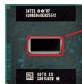
Processor Intel Atom ve skutečné velikosti (22 × 22 mm)
